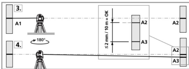
4. Girar o aparelho 180° e marcar o ponto A3. A diferença entre A2 e A3 é a tolerância.
