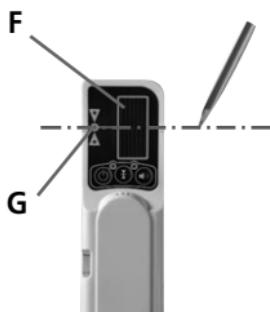
**Obs!** Lysintensiteten i en kryds/linielasers laserlinie er kraftigst på midten og aftager gradvis mod enderne. Derfor angives lasermodtagerens rækkevidde som et interval. Nærområdet: Grøn kontrollampe max. 7 – 15 m og Fjernområdet: Rød kontrollampe max. 30 – 50 m.
