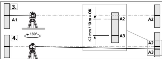
**4. Käännä laitetta 180° ja merkitse piste A3.** Pisteiden A2 ja A3 välinen erotus toleranssi.
