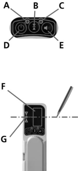
**Hinweis:** Die Lichtintensität der Laserlinien ist in der Mitte am höchsten und wird an den Enden geringer. Dadurch verändert sich auch die maximale Reichweite des Laserempfängers: Grüne LED max. 7 – 15 m, rote LED max. 30 – 50 m.
