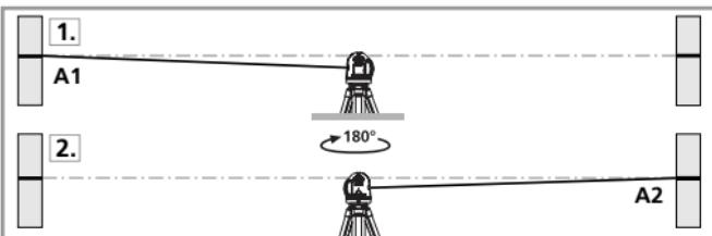
**2.** Drehen Sie das Gerät um 180° u. markieren Sie Punkt A2.
