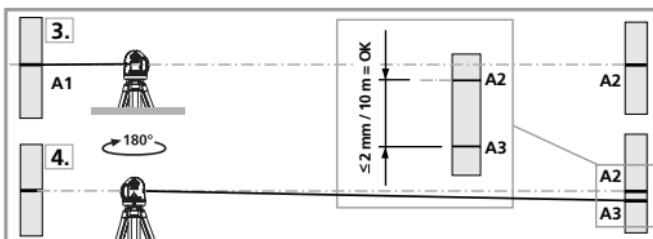
**4. Draai het toestel vervolgens 180° en markeer punt A3. Het verschil tussen A2 en A3 moet binnen de tolerantie van de nauwkeurigheid liggen.**
