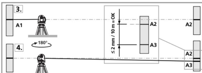
**4.** Drehen Sie das Gerät um 180° und markieren Sie den Punkt A3. Die Differenz zwischen A2 u. A3 ist die Toleranz.
