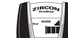
Continúe deslizando la herramienta. Cuando se localice el centro de la viga se muestran tres barras en el Signal Strength Indicator (Indicador de Fuerza de la Señal), y las cuatro barras centrales, la pantalla CENTER, y el Spotlite® todos se iluminarán, y la bocina sonará.
