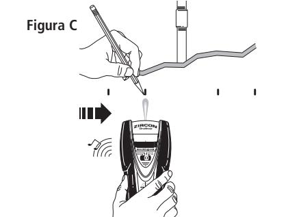
3. (Figura B) Para determinar con mayor precisión la ubicación del objetivo metálico, escanee el área nuevamente. Suelte el botón de encendido y active nuevamente la unidad, esta vez comenzando en la pared sobre una de las marcas previas. Esto reiniciará la herramienta a una sensibilidad más baja y limitará el área de escaneo.
